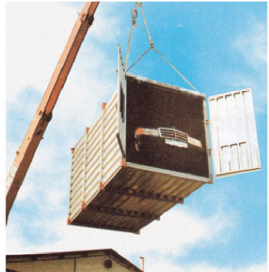
--Ohne Zusatzeinrichtung auch am Kran mit 1,5 Tonnen belastbar
