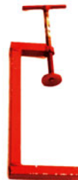
Zargenzwinde zur Befestigung an Tür und Fensterzargen
